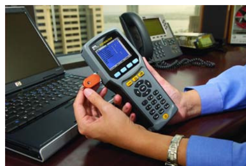
Kabel-Qualifizierer SIGNALTEK zur einfachen Leistungsanalyse von LAN-Verkabelungen.
