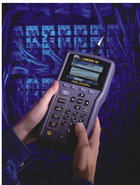
LAN-Kabeltester (Zertifizierer) LANTEK zum Nachweis der korrekten Installation einer strukturierten Verkabelung
