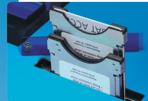
Option: 2x Common Interface (CI) zur Aufnahme aller gängigen CAM-Module.
