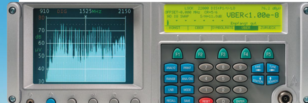
Das Farb-TFT (5.5") für optimale graphische Darstellungen. Abbildung: breitbandiges Spektrum SAT.
