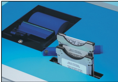
2 Common Interface zur Aufnahme der üblichen CAM-Module
