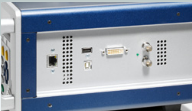
Alle Schnittstellen im Überblick: Ethernet RJ45, ASI in/out über BNC, USB-A, USB-B, SCART, DVI out.
