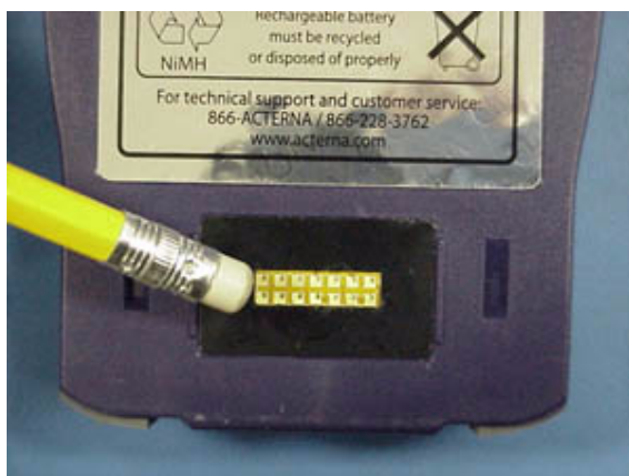
Figure 2 Nettoyage des contacts de batterie
