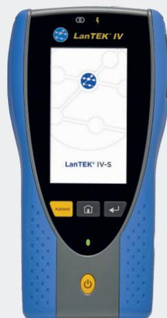
**So können Sie Tests nach Cat 5e/6/6A mit allen geforderten und optionalen Messungen in nur 7 Sekunden ausführen und speichern.**
