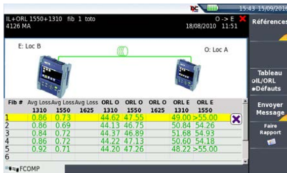
Figure 128 Résultats "Vue Câble"
