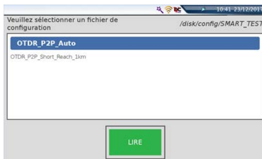
Figure 13 Chargement du fichier de configuration Smart Test
