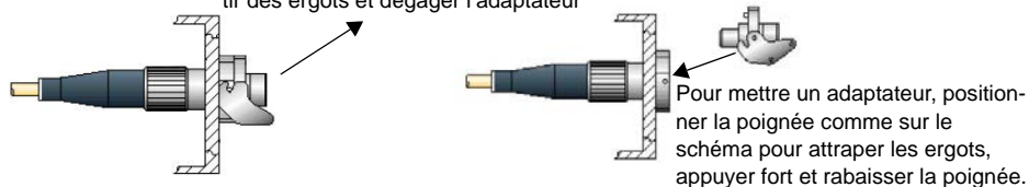
Figure 8 Enlever et remettre un adaptateur Tirer dans le sens de la flèche pour sortir des ergots et dégager l'adaptateur
