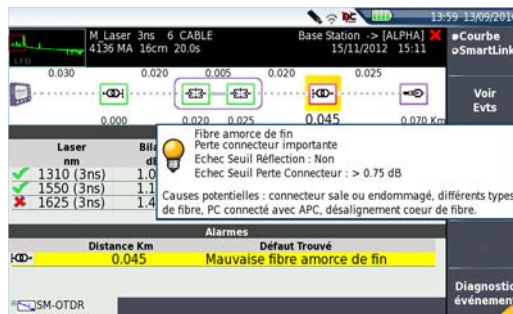
Figure 76 Fenêtre Diagnostic Événement
