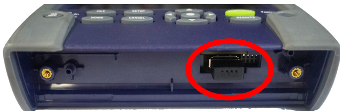
Figure 41 USB WIFI installé dans la Plate-forme
