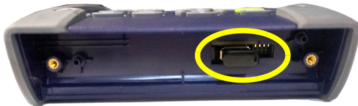
Figure 36 USB Bluetooth installé dans la Plate-forme
