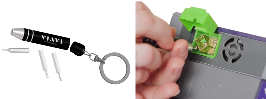
Abb. 4 Adapter am Modul tauschen
