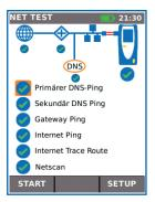
Anzeige des Netzwerkplanes zum Prüfen der Ergebnisse für die einzelnen Netzelemente.
