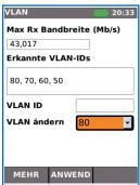
Die automatische Erkennung von VLAN-IDs erlaubt dem Anwender, den NaviTEK NT für den Betrieb in einem VLAN einzurichten.
