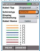
Arbeiten Sie mit einer umfassenderen Vorlagenliste für den Verdrahtungstest mit gängigen Ethernet-Kabeltypen sowie anderen Kabeln, wie Profinet, ISDN und Deutsche-Bahn-Kabel.
